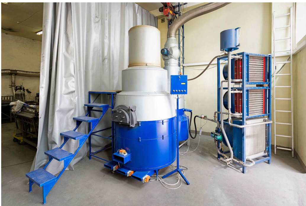
ФІГ. 1. Наші газифікатори 2016 року (а, що переробляє 30 кг відходів за годину) та 2018 року (б, що переробляє 80 кг відходів за годину).
