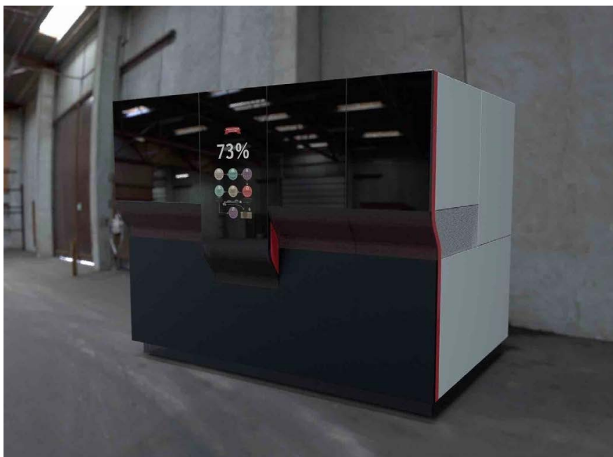
Фіг. 2. Конструкція промислового газифікатора (площа основи газифікатора, яка перероблятиме 1 т на годину, становить 10 кв. м, висота – 2 м).
